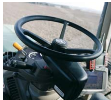
Ten mechanizm sterujący ciągnikiem na podstawie sygnału GPS, który montowany jest na kolumnie kierownicy, można przenosić do wielu innych maszyn.
